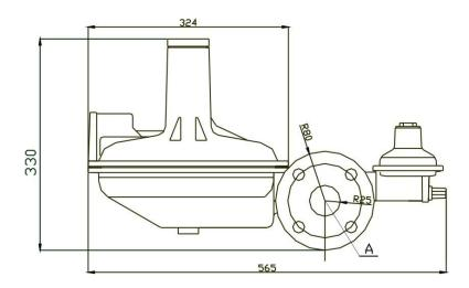
Регулирующую камеру регулятора можно повернуть вокруг оси A на 360°
