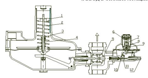
Монтаж регулятора на линии производится согласно направлению стрелки на корпусе, указывающей направление потока газа. При надлежащей проверке на герметичность разъемных соединений работник газового хозяйства приступает к пуску регулятора.
